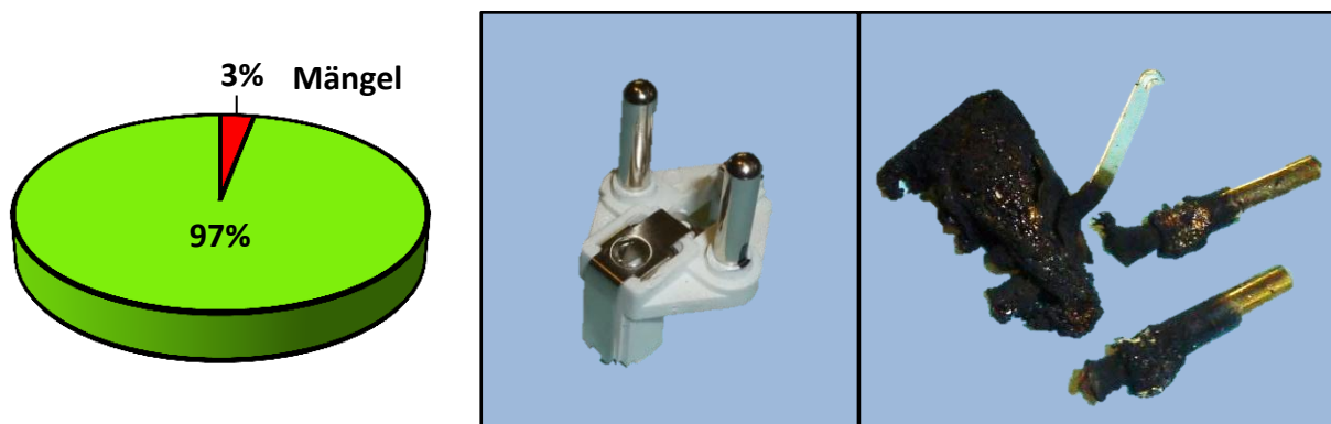
Abbildung 6: Beständigkeit des Isolierstoffs, vor und nach der Glühdrahtprüfung
