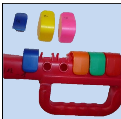
Abbildung 3: Spielemusikinstrument Trompete mit abgelösten und verschluckbaren Tasten
