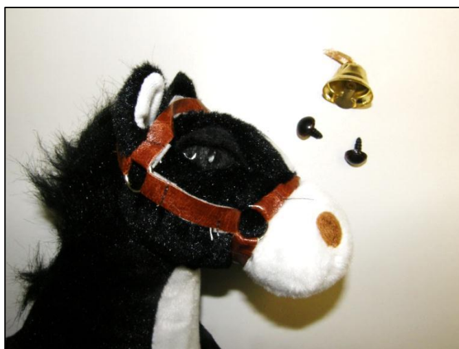
Abbildung 4: Verschluckbare Kleinteile nach der Zugprüfung
