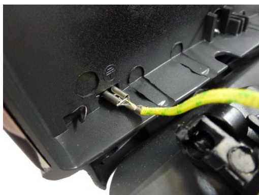
Abbildung 1 Flachsteckverbindung des Schutzleiters
