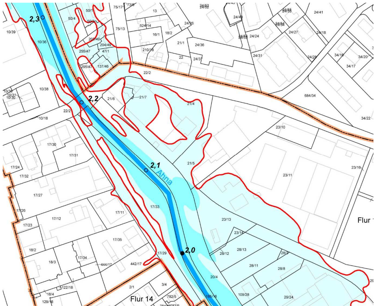
Abbildung 4: Beispielfläche zur Unterscheidung von Abflussgebiet (dunkelblau) und Staubereich (hellblau)
