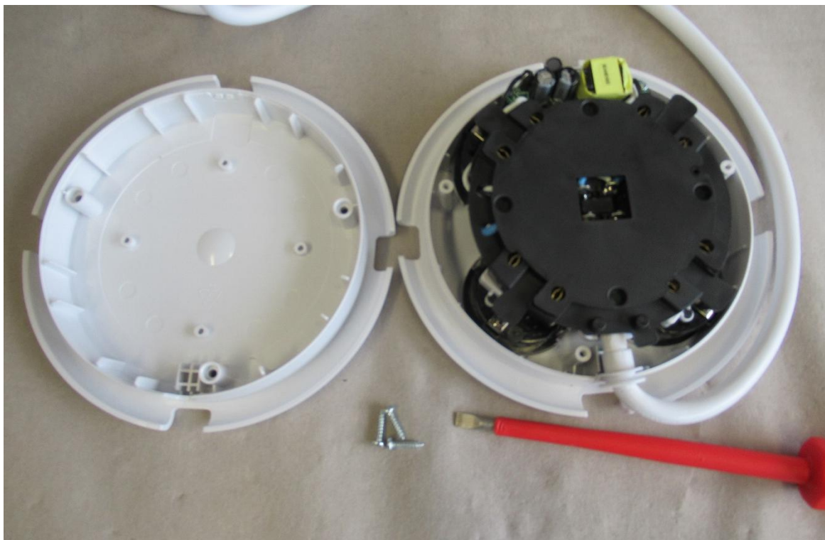
Abbildung 6: Beispiel, mit gängigem Schraubendreher geöffnete Mehrfachsteckdose / Leitungsroller
