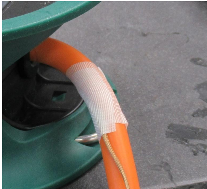
Abbildung 5: Beispiel, Temperaturmessung am Leitungsmantel
