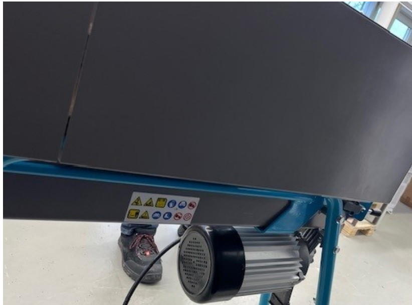
Abbildung 2: Warnhinweise unter dem Gerät auf der Rückseite des Arbeitsbereiches sind für den Bediener nicht sichtbar
