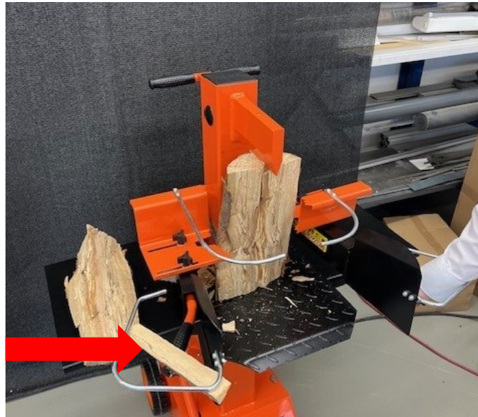
Abbildung 1: Zweihandschaltung kann mit Holzstück umgangen werden.
