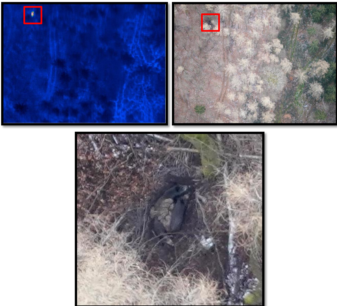
Abbildung 2 a), b), c): IR VIS Bildpaar eines Wildschweinkessels (mit Frischlingen) und vergrößerter Vis Bildausschnitt / Detektionsereignis Nummer 108 vom 15. Februar 2025
