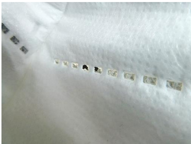
Abbildung 12: Löcher in Verschweißung
