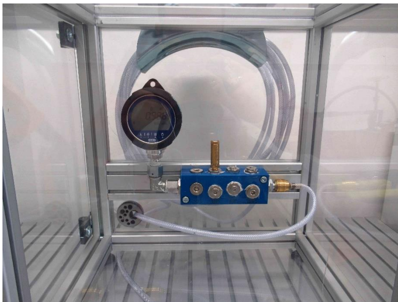
Abbildung 1: Prüfaufbau für den Ansprechdruck von Sicherheitsventilen.
