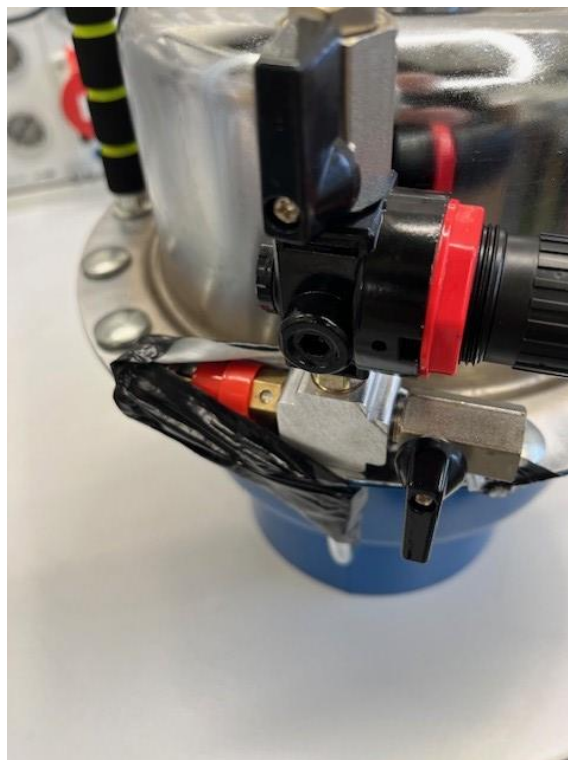
Abbildung 5: Beispiel der Manipulation eines Sicherheitsventils am Bremsenentlüftungsgerät
