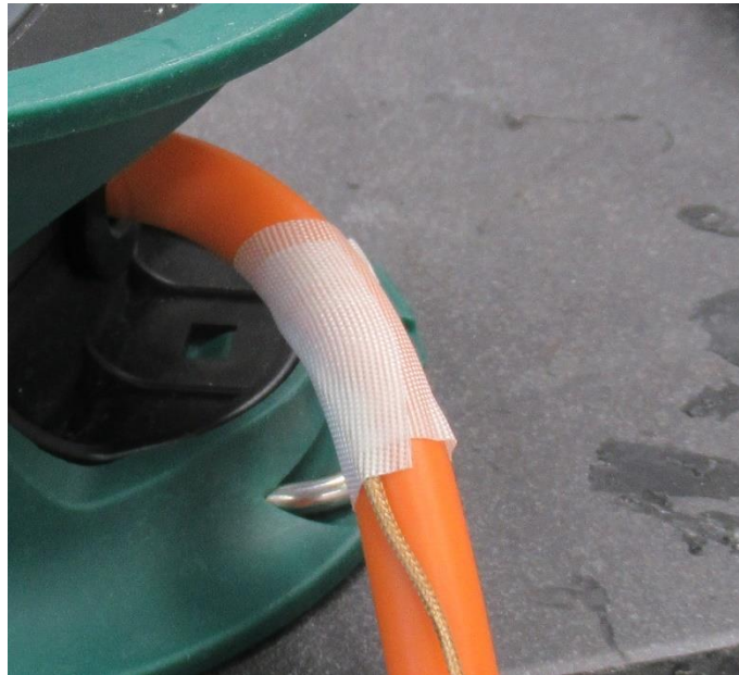
Abbildung 5: Beispiel, Temperaturmessung am Leitungsmantel
