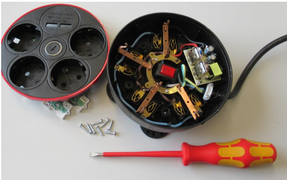
Abbildung 6: Beispiel, mit Schraubendreher geöffnete Mehrfachsteckdose / Leitungsroller
