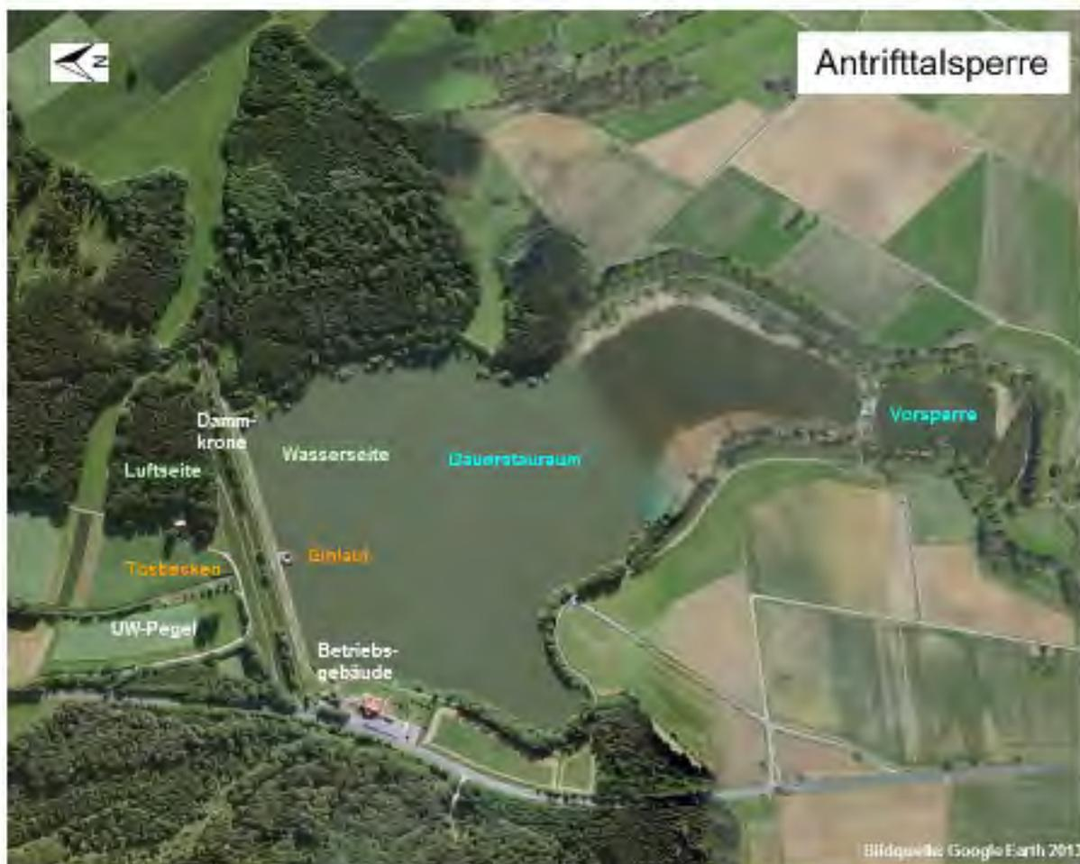
*Bild 2: Luftbild der Antrifftalsperre mit Anlagenteilen*
