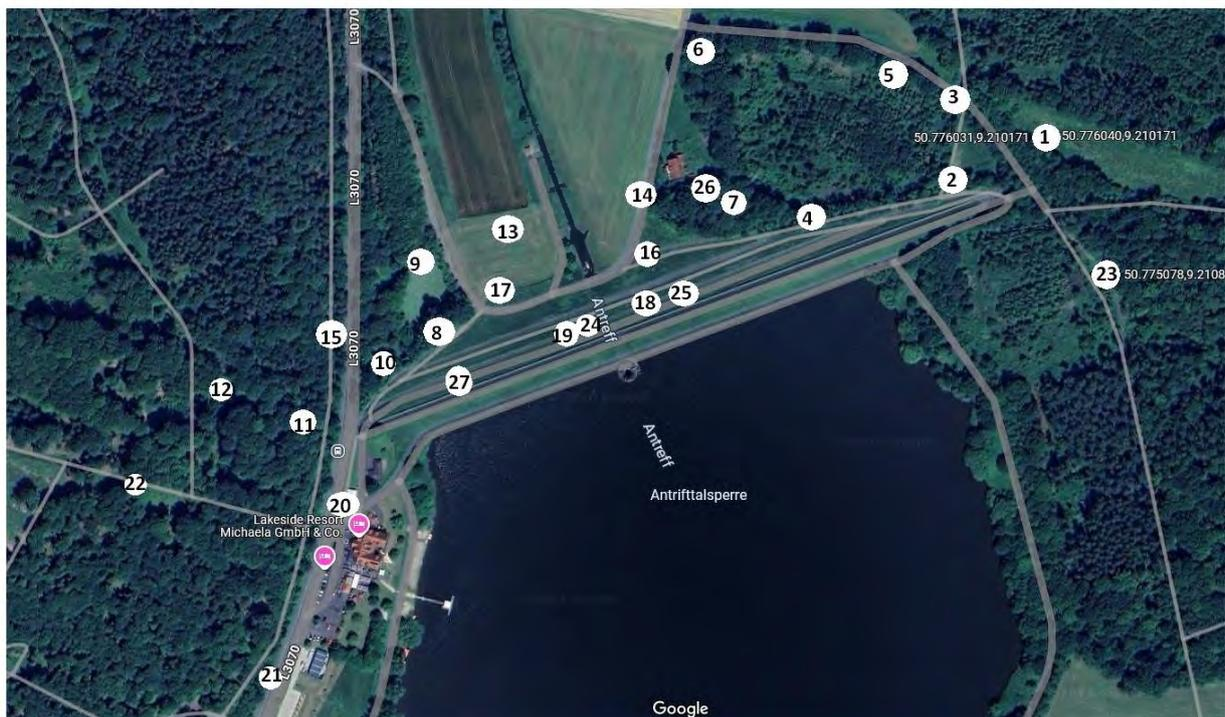
Bild 14: Lage der Grundwassermessstellen
