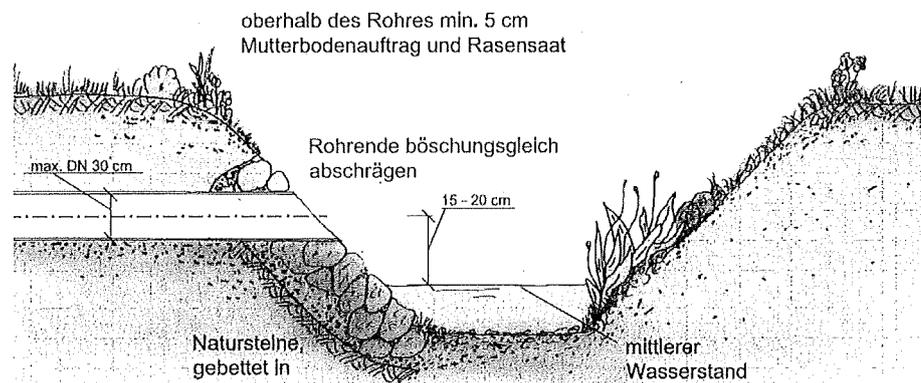
Beispiel für eine Uferböschung die steiler als 1:2 geneigt ist. Hier muss um Ausspülungen zu vermeiden, um das Rohr herum, sowie bis zum Böschungsfuß die Einleitung befestigt werden.
