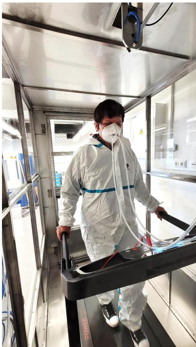
*Abbildung 10: Probandin auf Laufband bei der Leckageprüfung*
