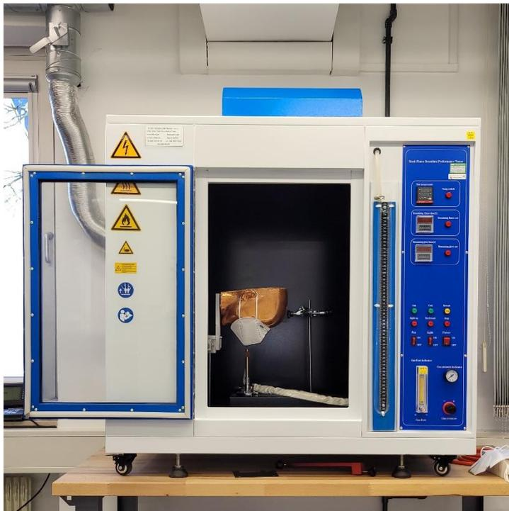
Abbildung 7: Entflammbarkeitsprüfgerät
