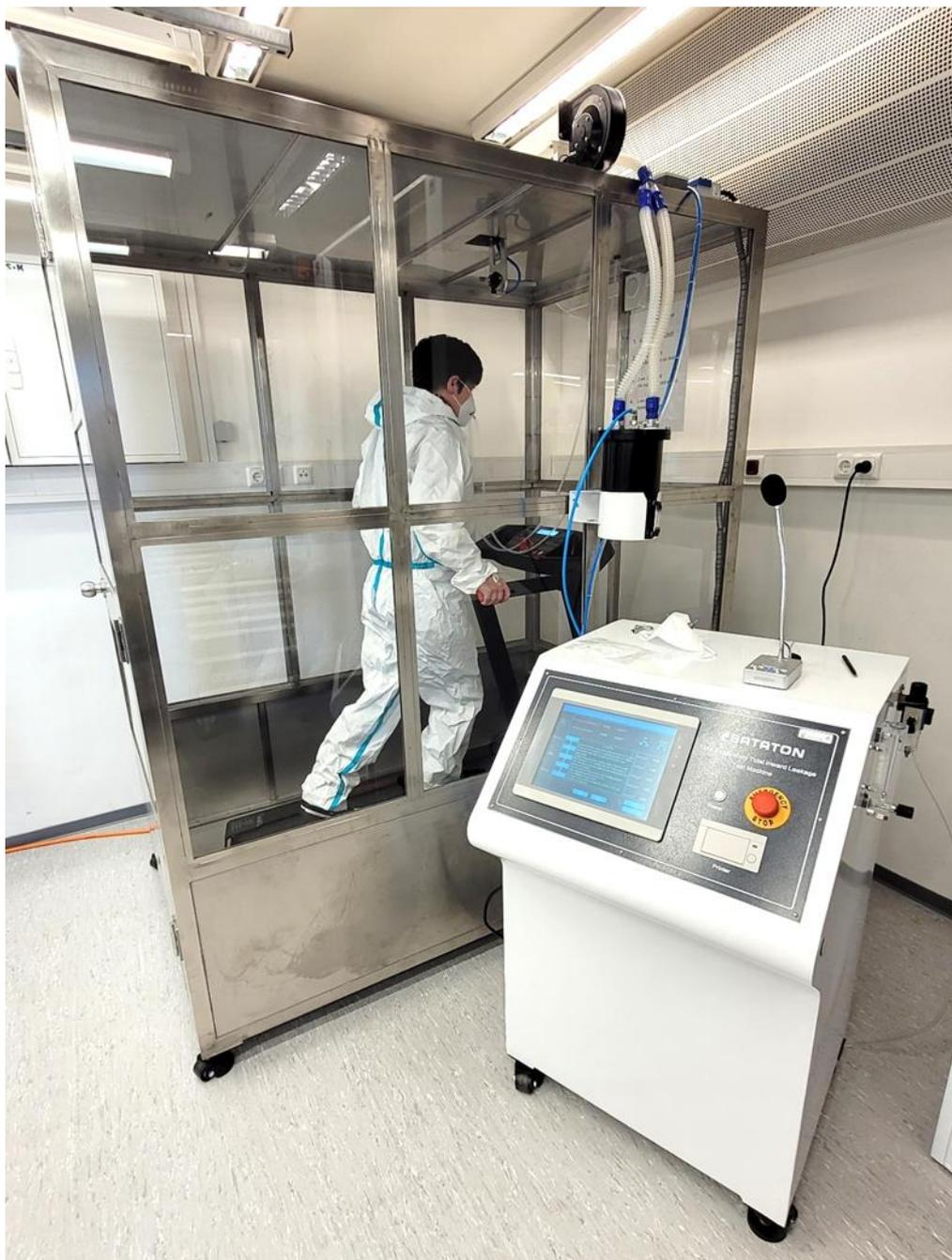
Abbildung 9: Leckageprüfstand mit Kabine
