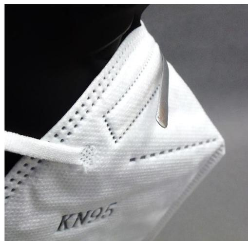
Abbildung 13: Abgelöste Nasenbügel
