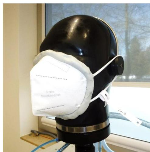
Abbildung 4: Sheffield-Prüfkopf mit Maske
