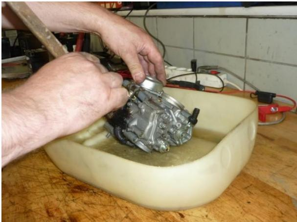
**Abbildung 1:** Reinigung des Vergasers
