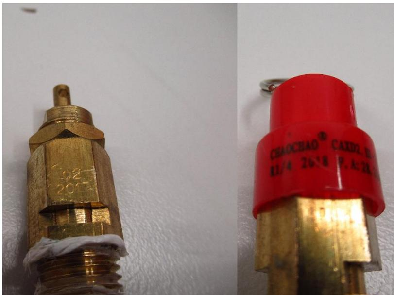
Abbildung 3: Abweichende Herstellungsjahre an einem Sicherheitsventil
