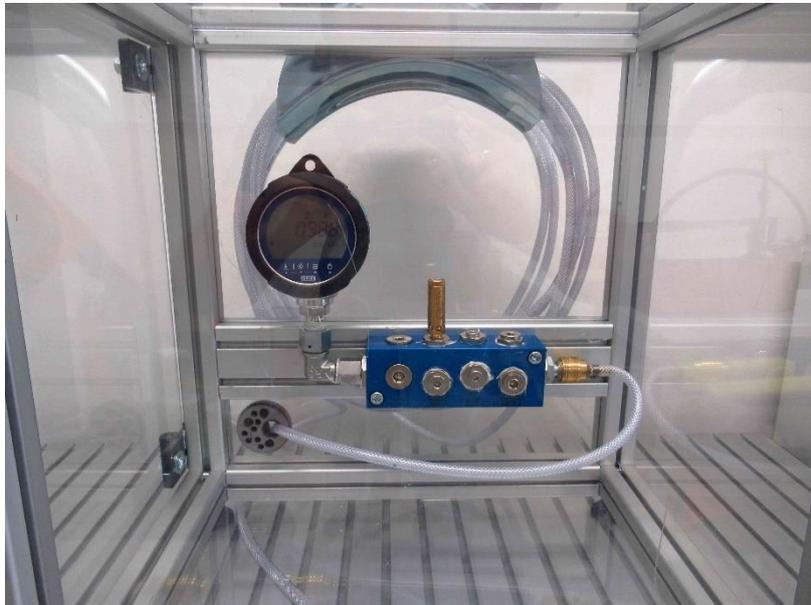
Abbildung 1: Prüfaufbau für den Ansprechdruck von Sicherheitsventilen.
