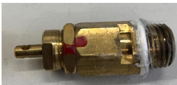
Abbildung 4: gebrochener Lackstrich an einem Sicherheitsventil
