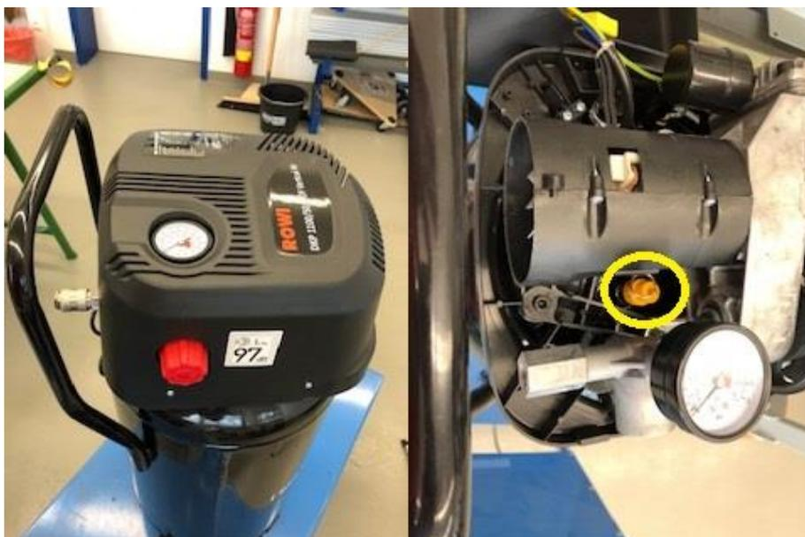
Abbildung 6: Beispiel eines versteckt verbauten Sicherheitsventils
