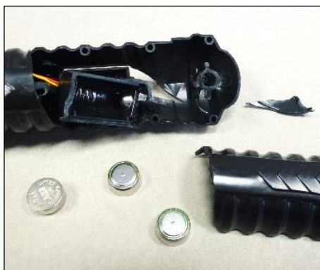
Abbildung 8: Das Gehäuse war bei der Überprüfung der mechanischen Festigkeit zerbrochen, die Knopfzellen fielen heraus.
