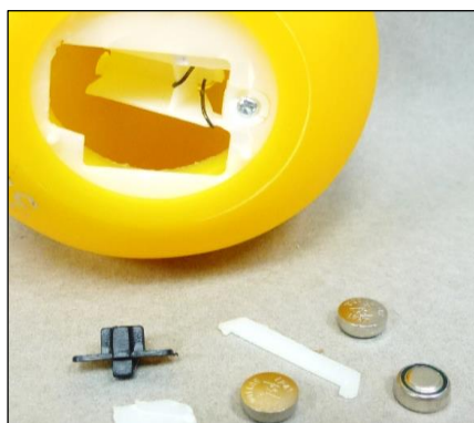
Abbildung 7: Das Batteriefach war bei der Überprüfung der mechanischen Festigkeit zerbrochen, die Knopfzellen fielen heraus.
