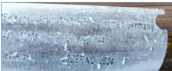
Abbildung 6: Unlesbare Kennzeichnung einer Öllampe nach dem Wischtest
