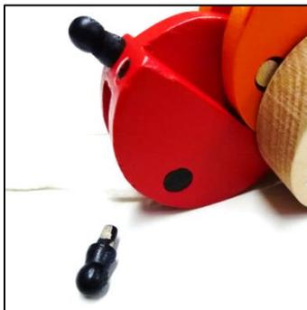
Abbildung 5.5: Bei der Zugprüfung löste sich der Fühler vom Nachziehspielzeug ab.
