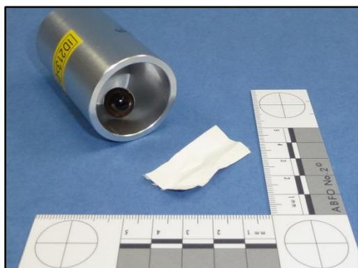
Abbildung 5: Kleine Teile in Prüfzylinder
