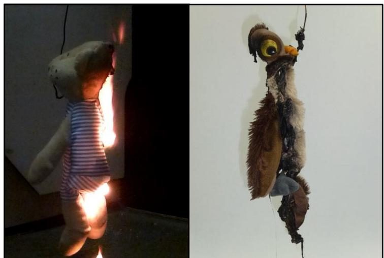
Abbildung 6: Entflammbarkeitsprüfung
